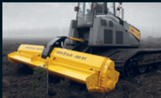
Для фрезерования торфяных участков. MERI MJK-480 DTX
