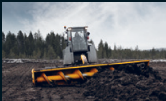
Для профилирования торфяных участков. Шнековый профилировщик MERI RT-6.0 T
